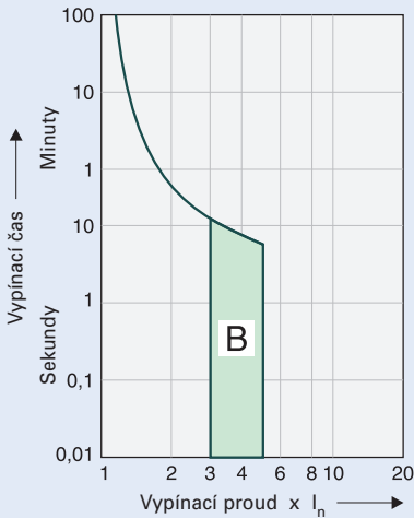
Vypínací charakteristika B (zkrat. spoušť 3–5 I_n )
